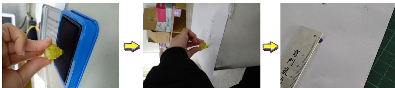
將底部軸心圓底拓印於白紙上，再以直尺測得拓印之圓形直徑為 0.4cm，接觸戰鬥盤的面積為 0.1256 平方公分，為尖底的 16 倍
