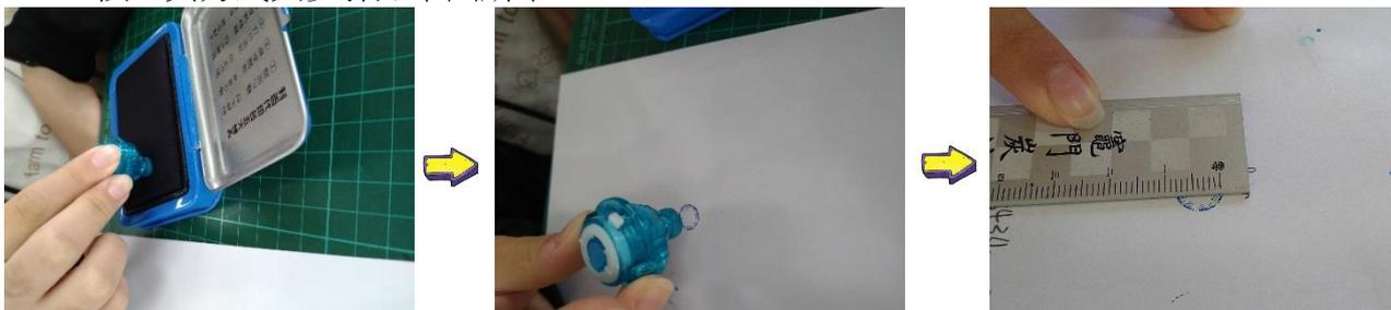
將底部軸心平底拓印於白紙上，再以直尺測得拓印之圓形直徑為 0.8cm，接觸戰鬥盤面積為 2.0096 平方公分，為尖底的 256 倍，圓底的 16 倍
