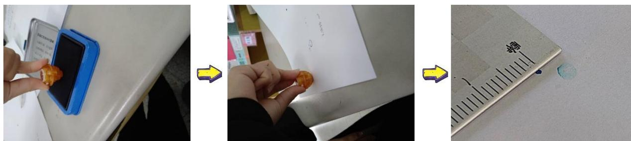
將底部軸心尖底拓印於白紙上，再以直尺測得拓印之圓形直徑為 0.1cm，接觸戰鬥盤的面積為 0.00785 平方公分
