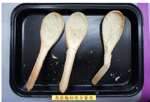
高筋麵粉混合蛋液製成湯匙(2支斷裂)
