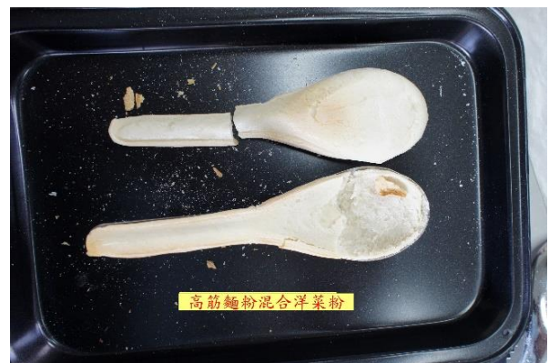
高筋麵粉混合洋菜粉製成湯匙(2支斷裂)
