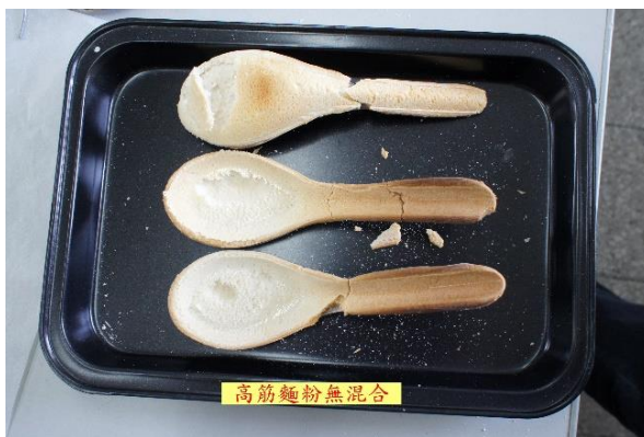
高筋麵粉無混合製成湯匙(都已斷裂)
