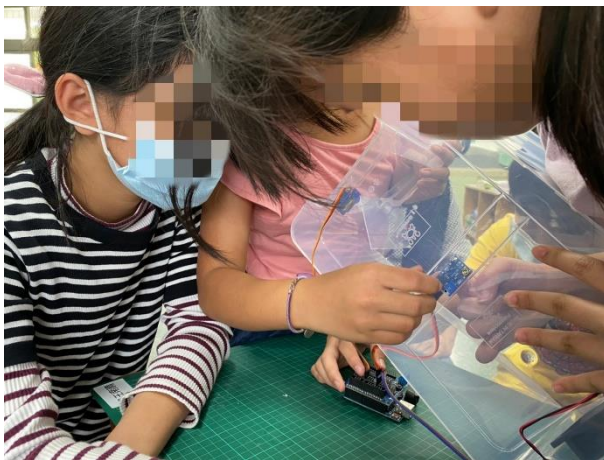
圖 7 鎖上MQ-2氣體感測器的螺絲
