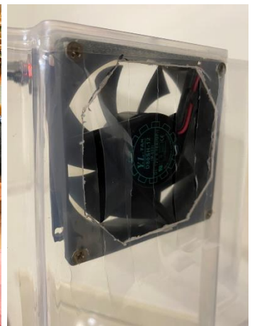
圖21 發現風扇隙縫過大
