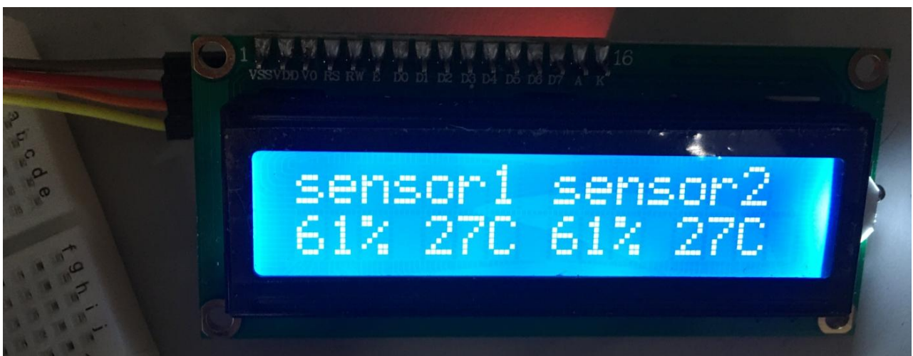
圖十八找到兩顆溫濕度顯示相同的 DHT11
