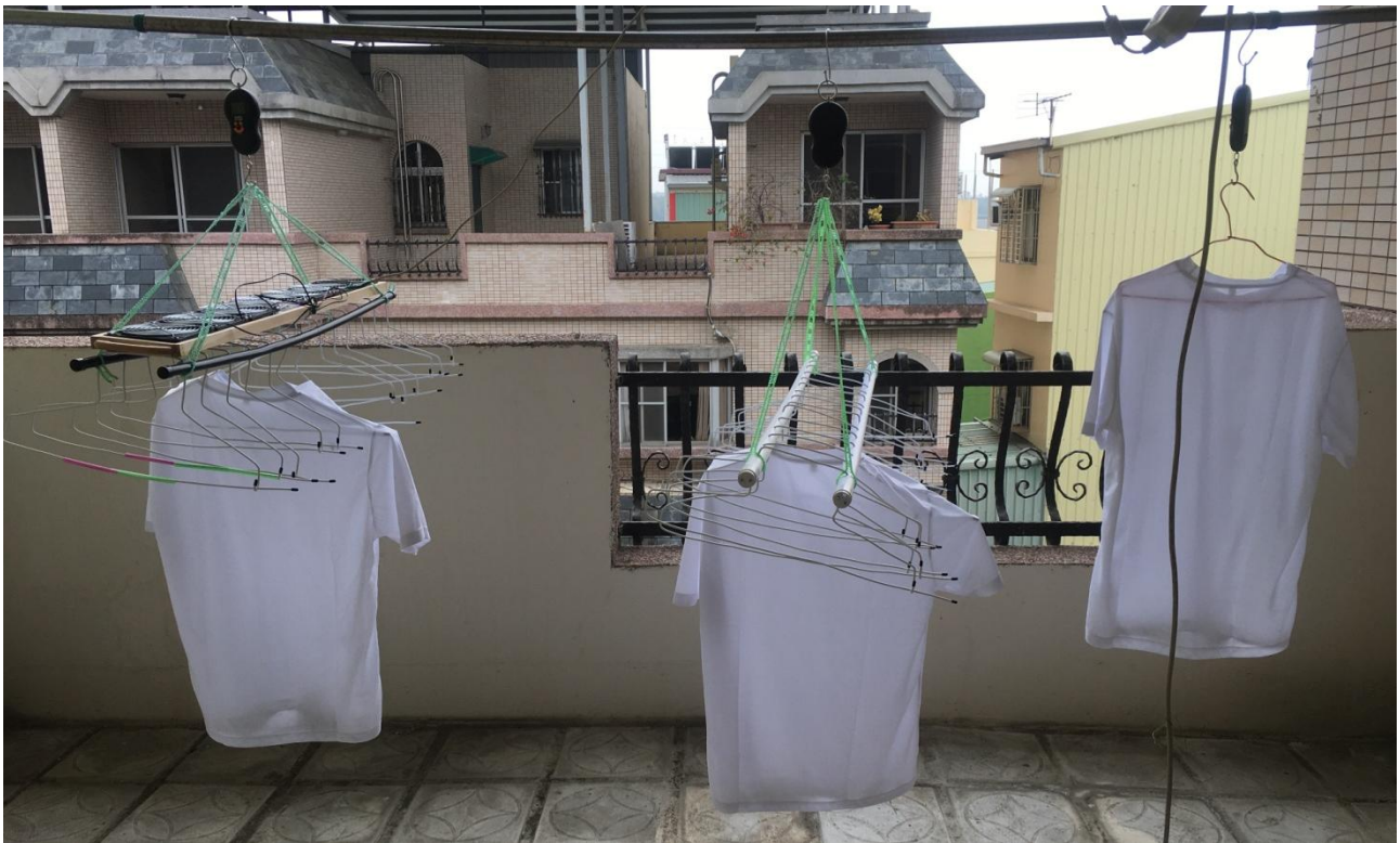
圖二十五由右而左分別為般衣架、平行衣架、平行衣架加風扇
