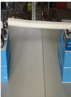
水平架設出超音波最上面偵測的木條
