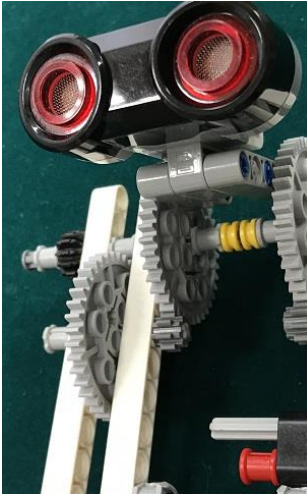
1.超音波上方偵測範圍，呈角錐狀放射
