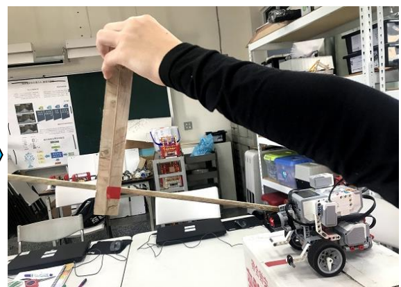
(2) 偵測到前方有物體就將木棒的高度調高，直到沒有聲音為止
