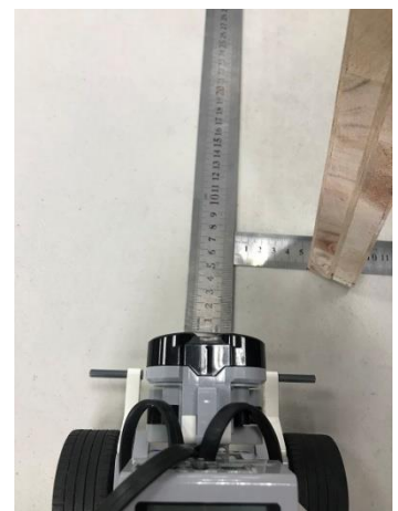
(3) 隔 5cm 向左右延伸測量，直到偵測不到物體
