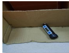
測量隔熱模型屋在室內燈光下屋內及屋外溫度
