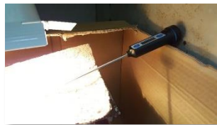
測量隔熱模型屋在室內燈光下屋內及屋外溫度
