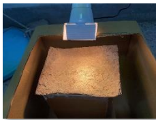
測量隔熱模型屋在室內燈光下屋內及屋外溫度
