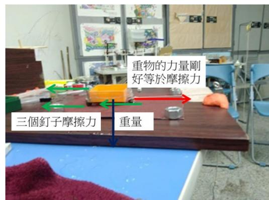
(圖七，力量水平的測量法。)
