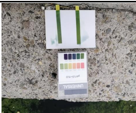
照片〈62〉大潭濕地水質酸鹼性檢測
