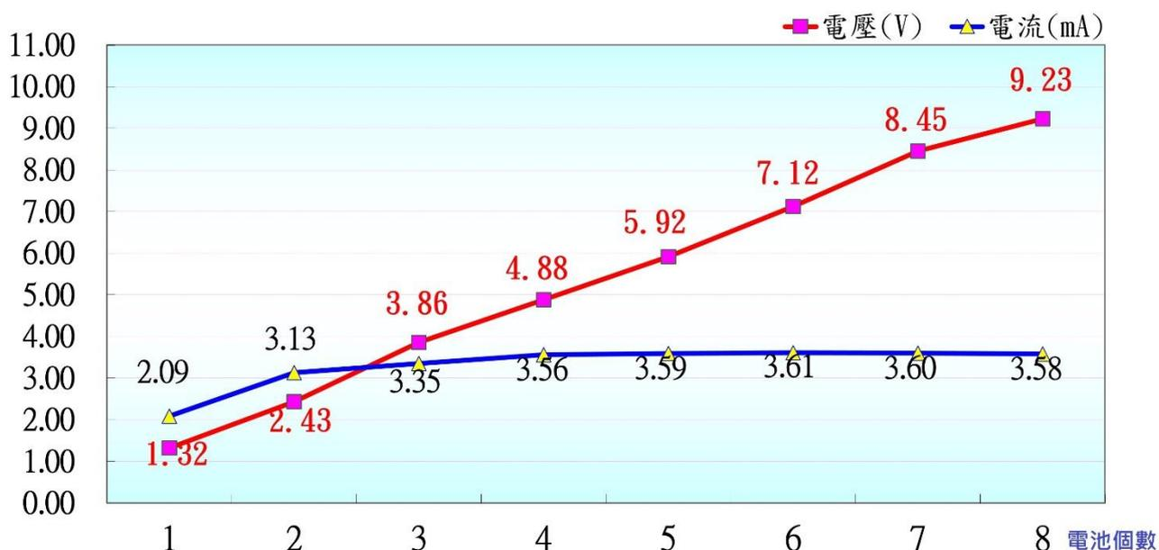
圖 5.5.1 林邊鄉水利村土壤電池不同串聯個數之電壓與電流變化圖
