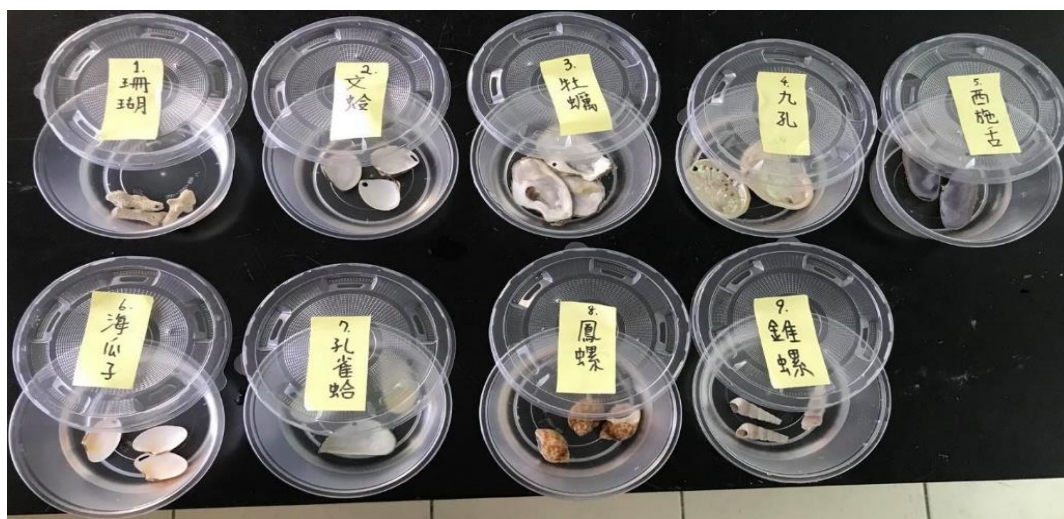
將不同有殼生物泡在不同 pH 值的溶液中
