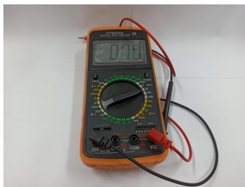
圖 3-7 用來測量電路中電壓
