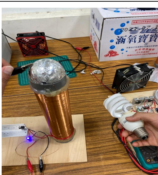
次線圈有接地，省電燈泡離較遠發光情形
