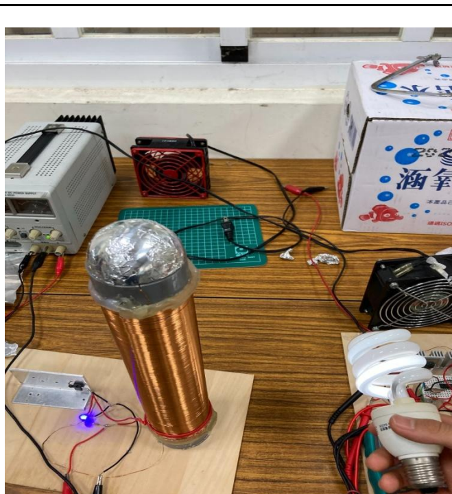
次線圈無接地，省電燈泡離較遠發光情形
