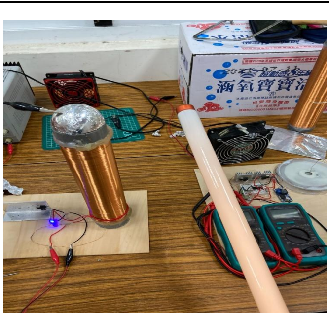
次線圈有接地，省電燈泡離較遠發光情形
