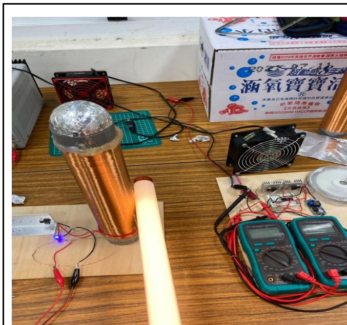
次線圈無接地，日光燈靠很近發光情形
