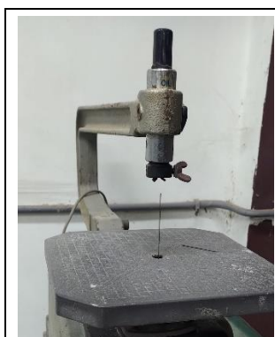
斷裂的線鋸條
