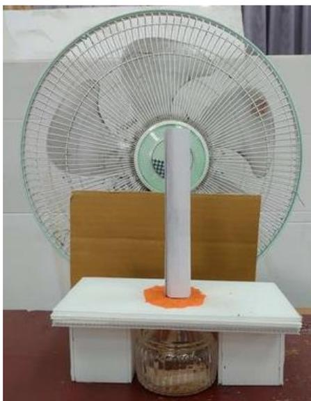
圖 6. 風速差異對火焰熄滅效果裝置圖
