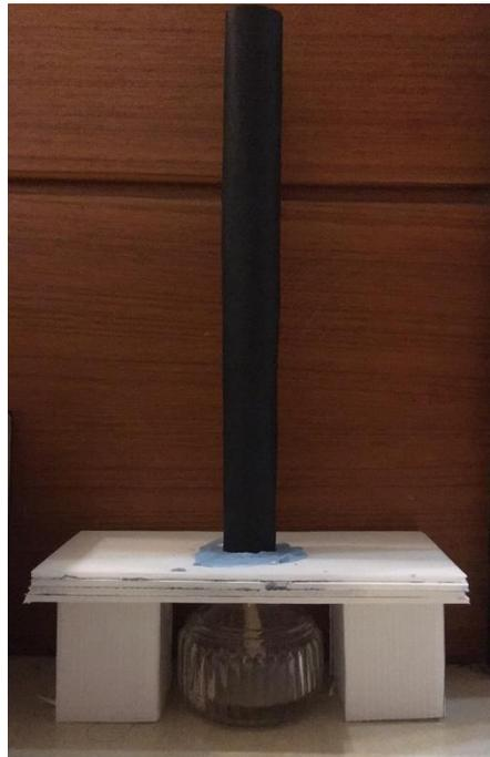
圖 4. 紙筒顏色差異對火焰熄滅效果裝置圖（黑紙）
