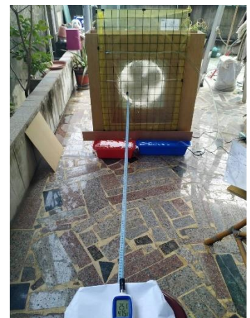
圖5 改變出風口、溫度計間的距離及濕度環境比較降溫效果
