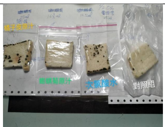
圖23 第七天:橘子皮原汁組與次氯酸水組已嚴重發霉，對照組輕微發霉，蟛蜞菊原汁剛開始發霉。
