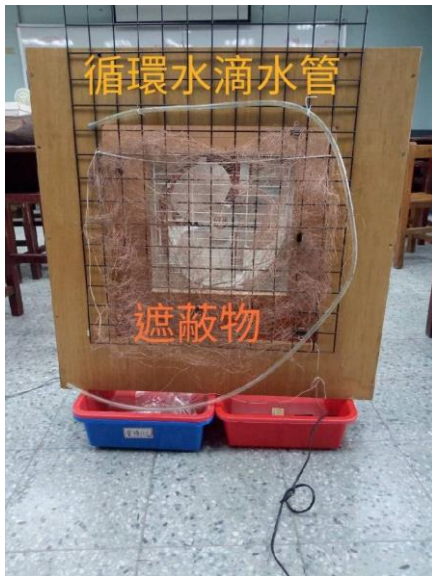
圖1 自製冷氣正面
