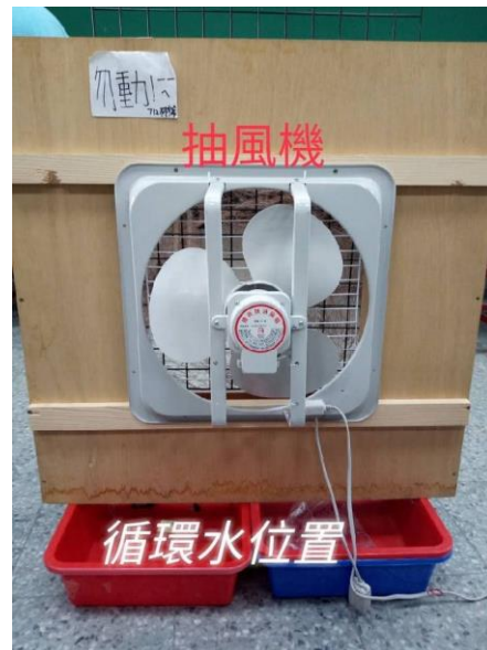
圖2 自製冷氣背面
