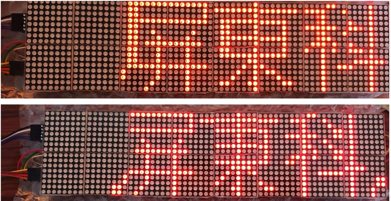
如上面兩圖所示，發現在每個 LED 元件與元件之間，發生訊號延遲出現的狀況，而且隨著時間越久，每行燈亮的時間也越久，已經快要沒有跑馬燈的效果出現。我們嘗試修改了程式，認為是否越到後面的迴圈裡面的程式碼太多導致。但我們回頭看了 4 個字的 8\*8 跑馬燈並沒有此現象。
