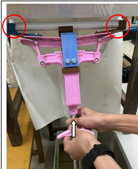
(4) 拉桿上拉，使兩側推桿向外拉直，燈座彈簧被壓入。
