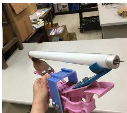
(3) 燈管輕放於外推片 C 環處，並旋轉燈腳呈水平狀態。
