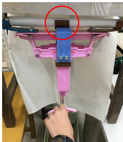
(5) 整枝拖把用力向上頂，使中間 C 型環也扣住燈管。
