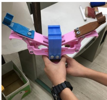
(2) 海棉拖把拉桿拉下，使推桿略呈內凹狀態。
