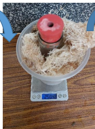
30 分鐘後，將水倒出， 測量最後重量(B)
