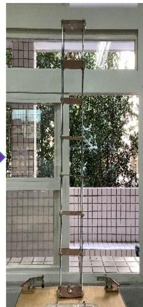
8. 新大樓測量震動大小我們改用手機APP:phyphox 中的程式來測量，方法同上，只是把Arduino晶片換成手機(老師心愛的)，仔細固定好手機，開始進行測量並記錄分析實驗結果。
