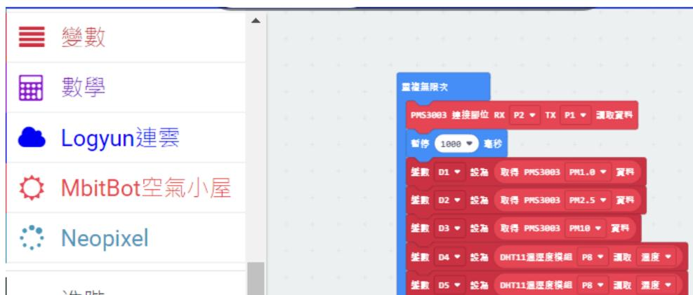
(4).設定程式如果變數 D2 數值小於 25 顯示笑臉圖樣、LED 燈帶顯示綠燈、數位腳位 16 繼電器為 0 關閉、5V 風扇電路斷路，若是變數 D2 數值小於 35 大於 25 顯示哭臉圖樣、LED 燈帶顯示橙燈、數位腳位 16 繼電器為 0 關閉、5V 風扇電路斷路，若是變數 D2 數值大於 35 顯示骷髏頭圖樣、LED 燈帶顯示紅燈、數位腳位 16 繼電器為 1 啟動、5V 風扇電路通路。
