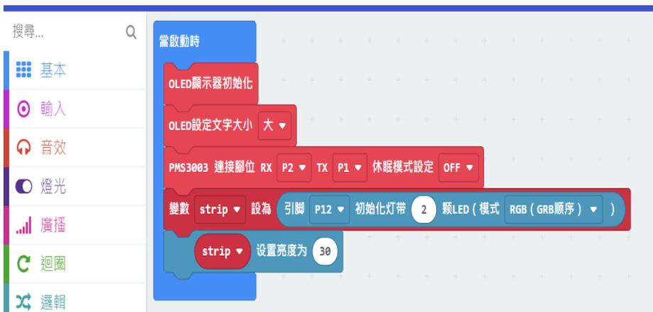
(2).背景運行程式中，設定 OLED 清除螢幕畫面並在(X,Y)共 4 列顯示文字 AirBox、PM1.0、PM2.5、PM10，並在 3 秒後清除畫面螢幕，並在(X,Y)共 4 列顯示文字 AirBox、Temp、Humid，OLED 即會在螢幕中顯示 PM1.0、PM2.5、PM10、Temp、Humid 的文字與數值。
