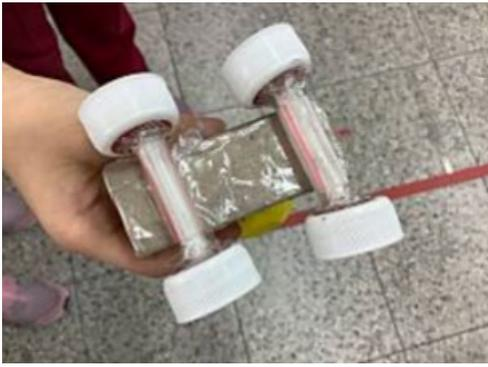
塑膠吸管包覆紙吸管輪軸
