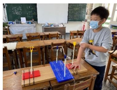
▲ 圖 11. 耐磨性實驗裝置實體圖
