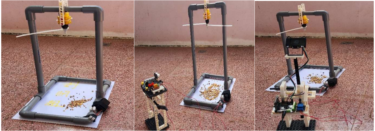
圖十一 對照組、超音波感應、AI 影像辨識三種感測裝置實際驅趕鳥擺設
