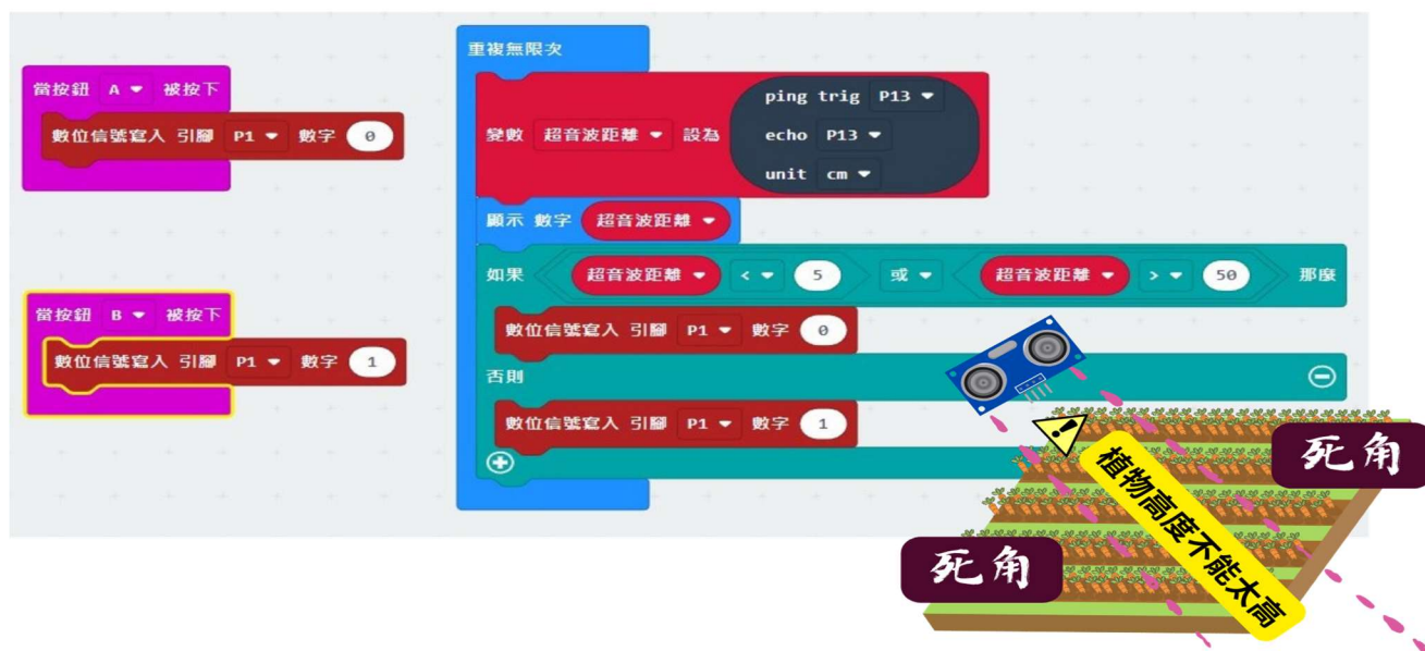
圖七 超音波感應程式碼以及檢測類比訊號示意圖
