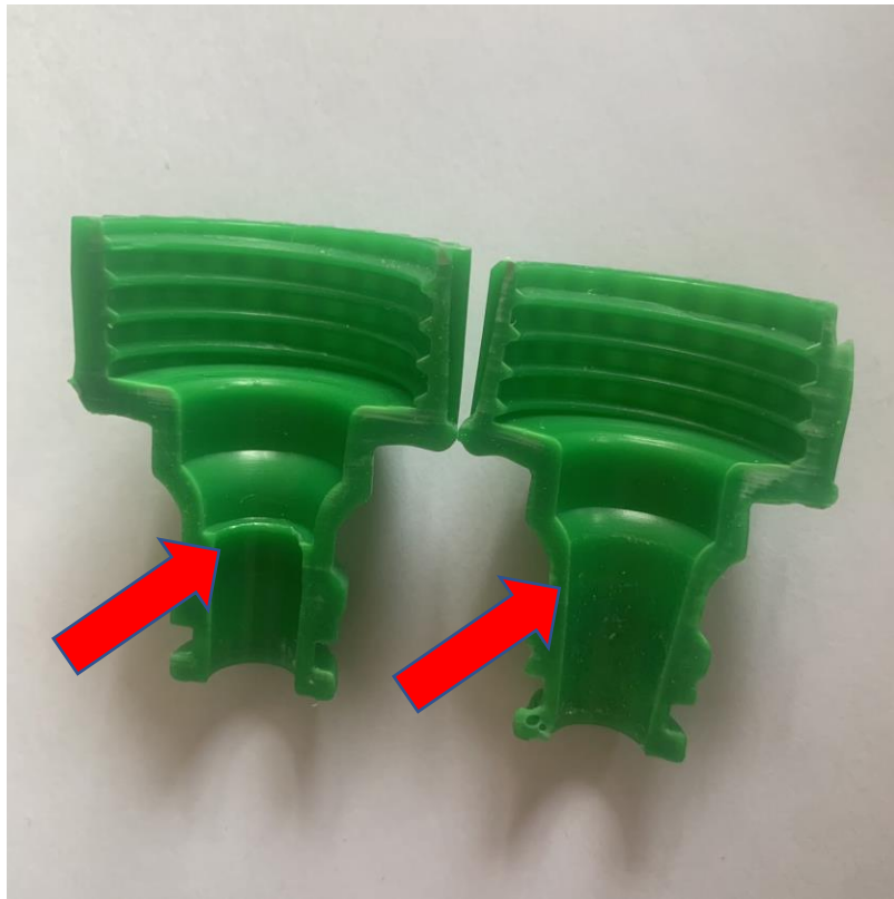
照片五、改良前、後水火箭噴嘴內部構造對照
