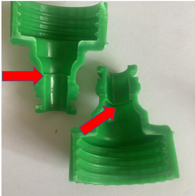
照片三、市售水火箭噴嘴內部構造
