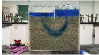
圖28. 30°C 純水的Bb流線路徑
