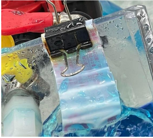
圖6. 入水孔分散水流裝置
