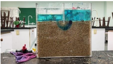
圖12. 25°C 純水的Aa流線路徑
