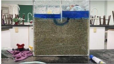
圖27. 30°C 純水的Aa流線路徑
