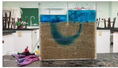
圖13. 25°C 純水的Bb流線路徑
