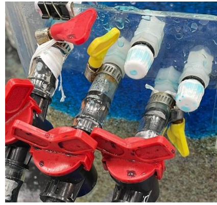
圖7. 入水孔控制流量用球閥
