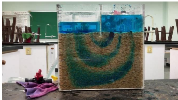
圖15. 25°C 純水的流線(後製合併)
