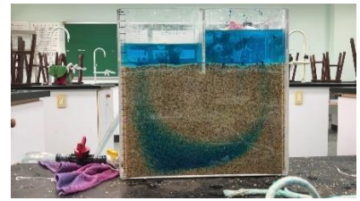
圖14. 25°C 純水的Cc流線路徑
