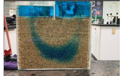
圖29. 30°C 純水的Cc流線路徑
