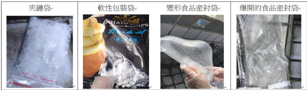
圖(12)為各類包裝袋爆炸後的狀態
