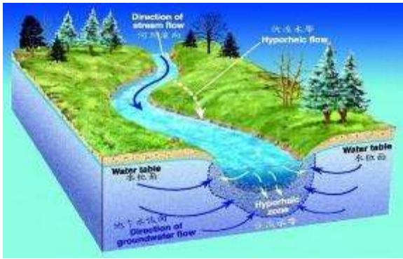
圖1: 河川伏流水3D模型（引自經濟部水利署南區水資源局高屏溪伏流水3D模型說明）
