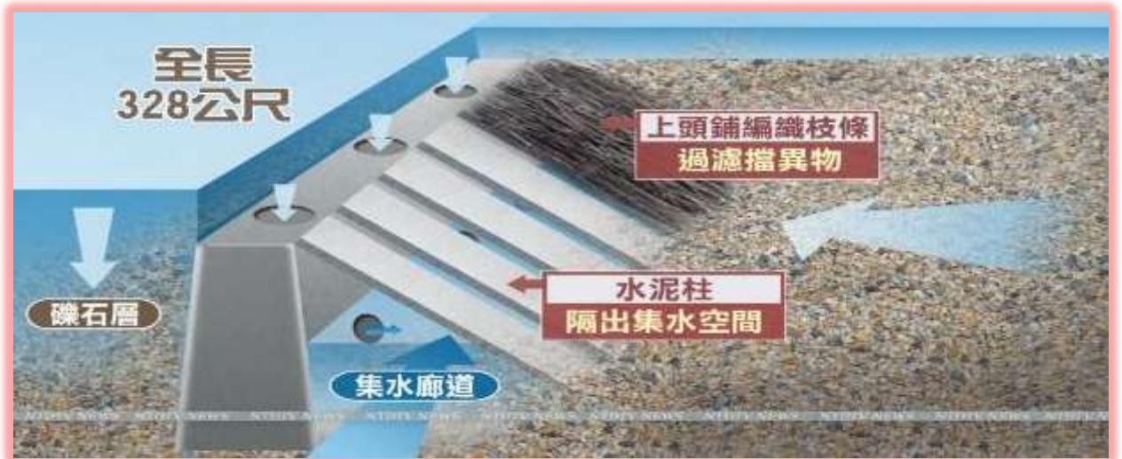
圖7.伏流水進入地下梯形堰堤示意圖(源自屏東縣政府及屏東林管處)
