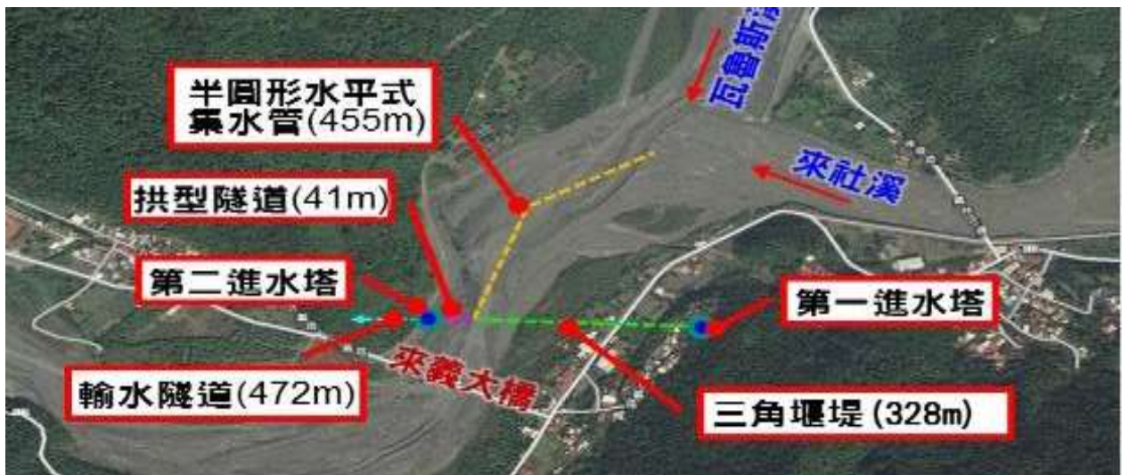
圖8. 林邊溪地下堰堤及導水路示意圖(源自屏東縣政府)
