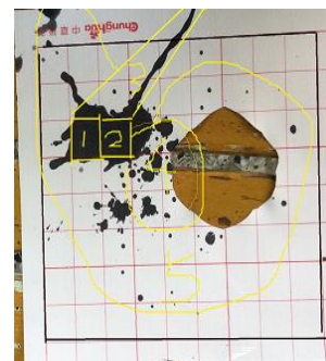
拍攝水寫紙上的噴水面積，計算面積大小
