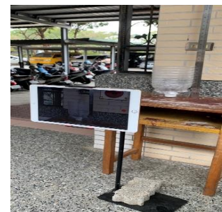
拍攝大便掉落時濺起水花的樣子
