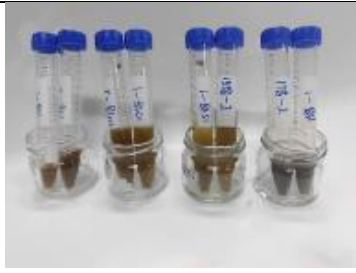
圖十：將樣品原液進行不同比例的稀釋。
