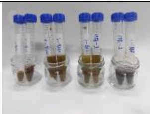
圖九：將樣品原液進行不同比例的稀釋。
