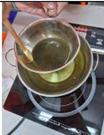
圖六：研磨成粉狀的的黃荊樹葉以 RO 水水煮 80°C，20 分鐘。
