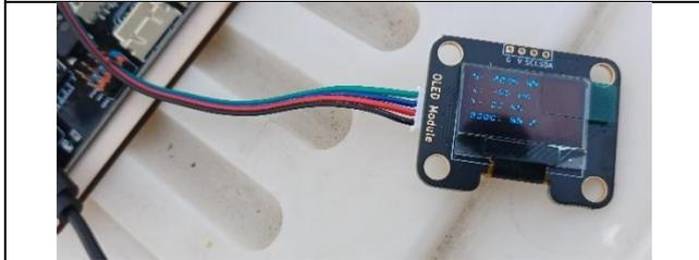
圖 16 OLED 屏顯示發電電壓、電流
