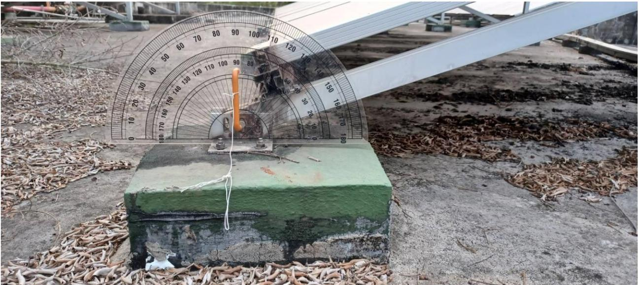
圖 9 學校太陽板與水平面夾角約為 18 度
