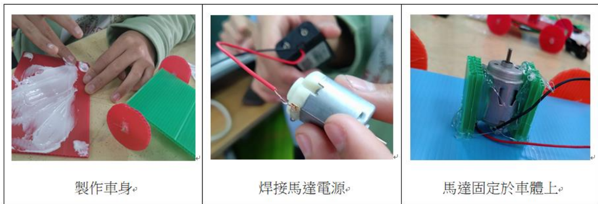
圖(1) 模型車製作與馬達安裝
