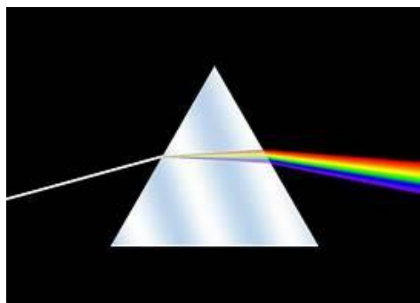
圖一為三稜鏡和被色散的光線
