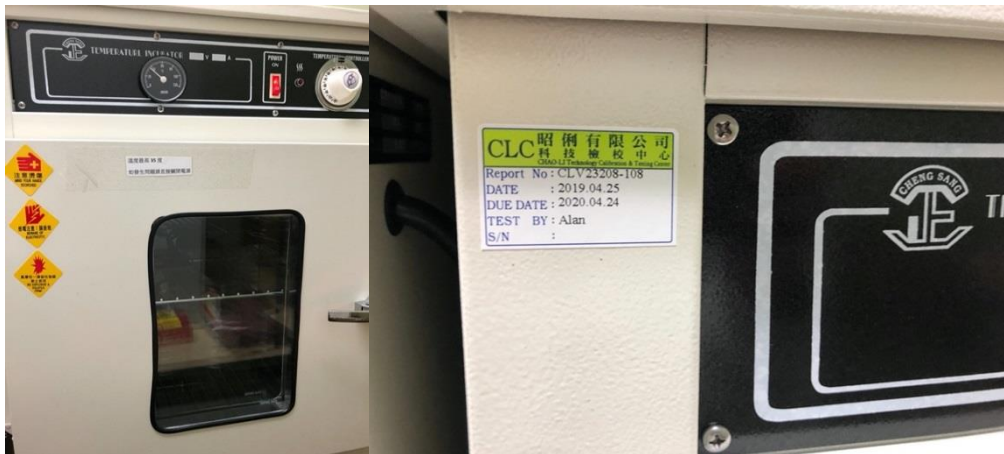
圖三、培養箱設定溫度及校正標籤
