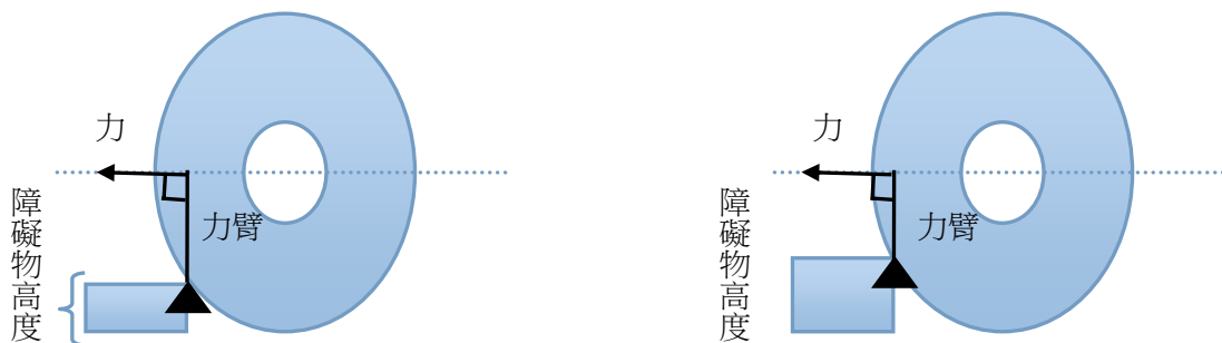
圖 6-7 輪子在越過障礙時，轉動的受力情形
