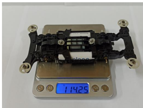
圖 3-5 在四驅車上加上小砝碼，讓每組實驗質量相近
