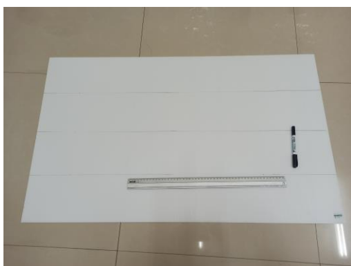
圖 3-8 在塑膠板上量好距離
