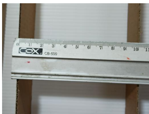
圖 3-13 跑道護欄間的距離 10.00cm，略大於導輪間距離
