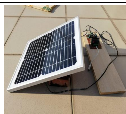
圖(16) 不同時間點的太陽高度角，其地表溫度變化測量太陽能板的發電功率
