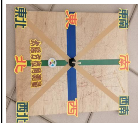
圖(17) 模擬太陽能板的安裝採仰角 25 度，面向南方，紀錄一天太陽高度角變化
