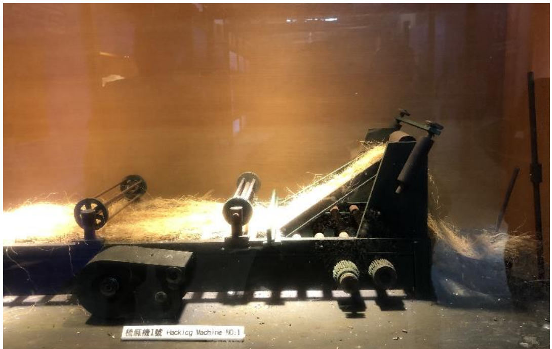
▲ 圖 27 型示範梳麻機運作情形
