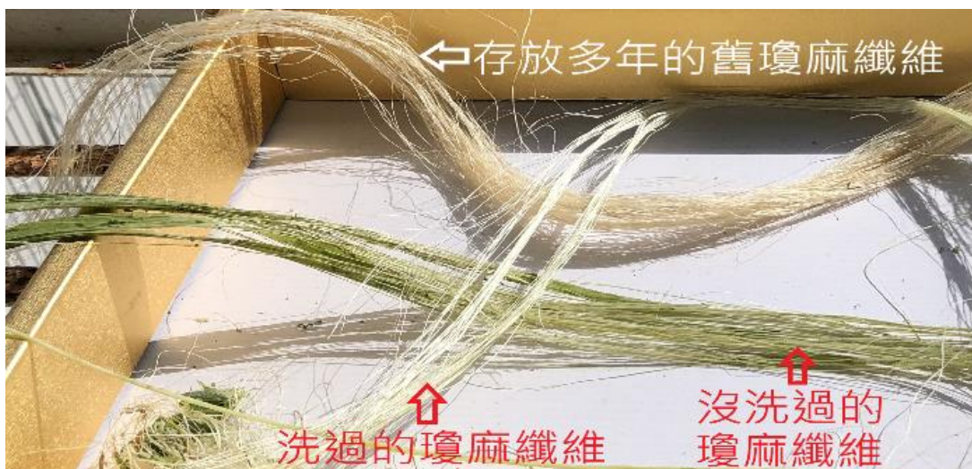
▲ 圖 31 洗淨曬乾的纖維與沒洗過的和老舊的纖維比較
