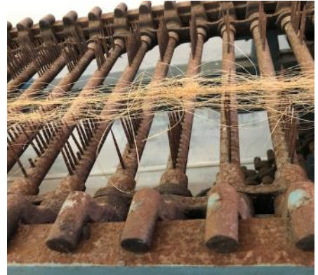
▲ 圖 24 纖維打包儲存 ▲ 圖 25 取出凌亂的纖維 ▲ 圖 26 釘梳將纖維梳開拉直
