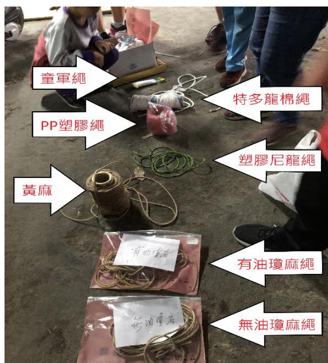
▲ 圖 59 準備多種繩索進行拉力測試
