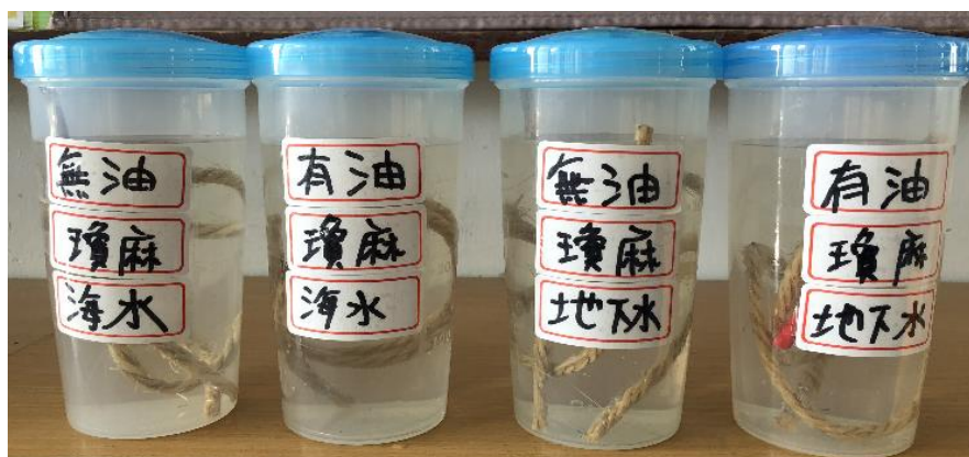
▲ 圖 56 將有油與無油的瓊麻繩分別泡在海水與地下水
