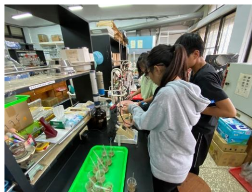
圖5.2.6 採樣土壤EC檢測過程抽取土壤溶出液
