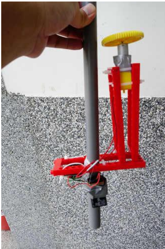
圖 21：保留手拉發射器手部空間，馬達位置提高
