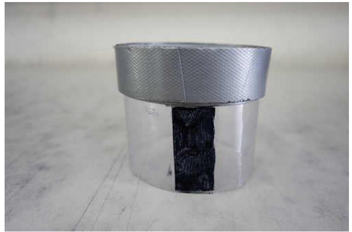
圖 2：飛行筒上做一條記號方便觀察旋轉速度
