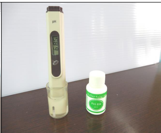
使用pH6.864的標準液校正(弱酸性)
