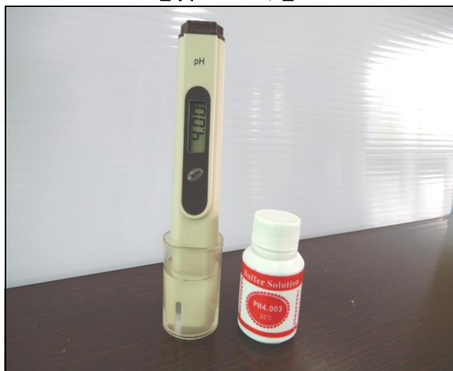
使用pH4.003的標準液校正(酸性)
