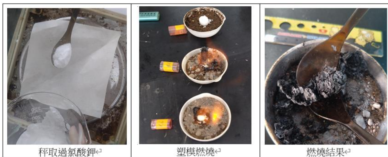
圖(11) 過氯酸鉀加蔗糖，再加入不同編號閃光紙的燃燒
