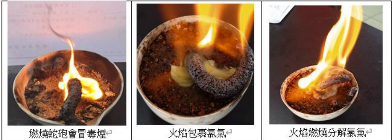
圖(39) 處理蛇砲燃燒的毒煙霧
