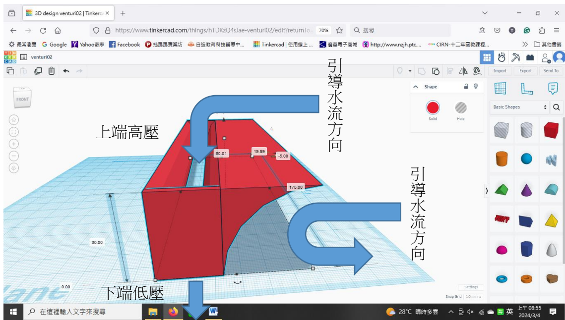
圖四、兩種消波塊結構體整合
