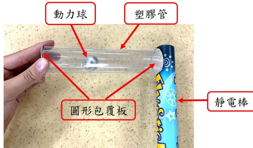
(三) 靜電動力球移動頻率測量方式：
