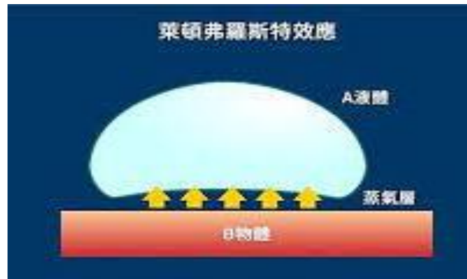
圖 1. 萊頓佛羅斯特效應示意圖（劉又瑋，2021）
