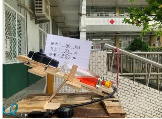
照片三、自製可調角度推力測試架(22 度)
