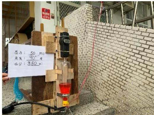
照片六、自製可調角度推力測試架(90 度)
