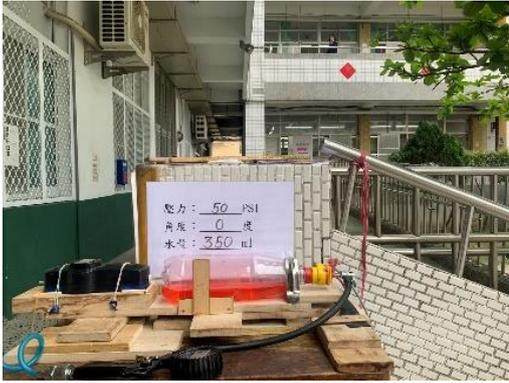
照片二、自製可調角度推力測試架(0 度)
