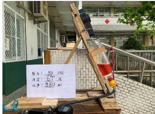
照片五、自製可調角度推力測試架(67 度)
