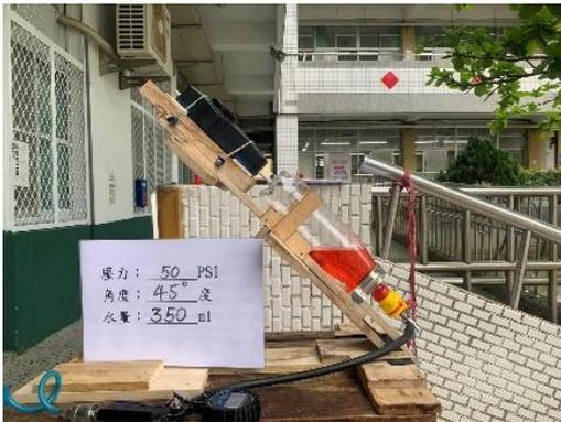
照片四、自製可調角度推力測試架(45 度)
