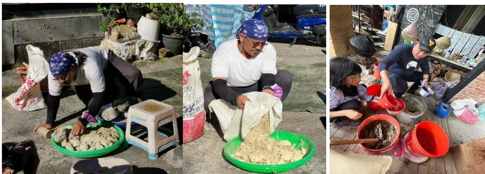
圖13:淨化陶土礦，(左)乾式處理、(右)濕式處理
