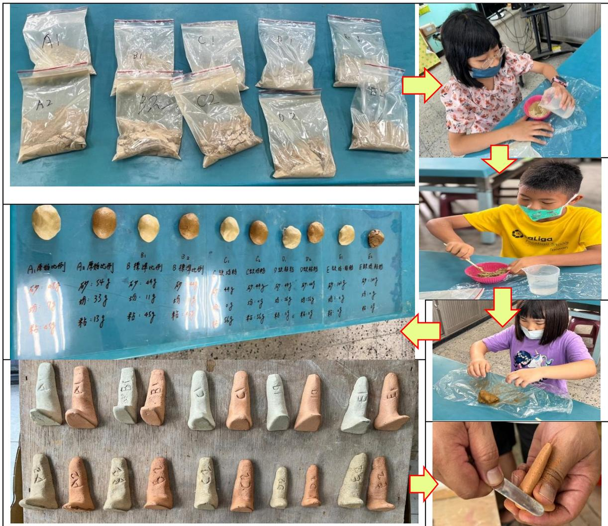
圖10:土壤質地分析:調配不同土壤→製陶(加水、攪拌、搓揉、捏製)→燒窯→刀削檢測
