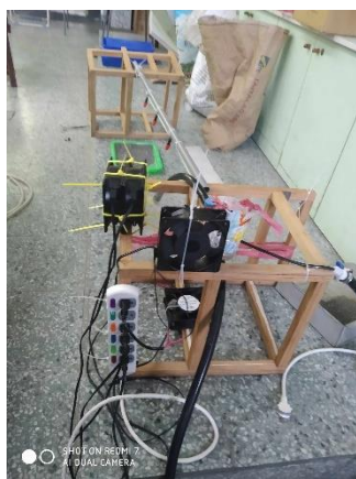
▲圖 2 降雨裝置(噴頭、軟水管、木條、電磁閥)
