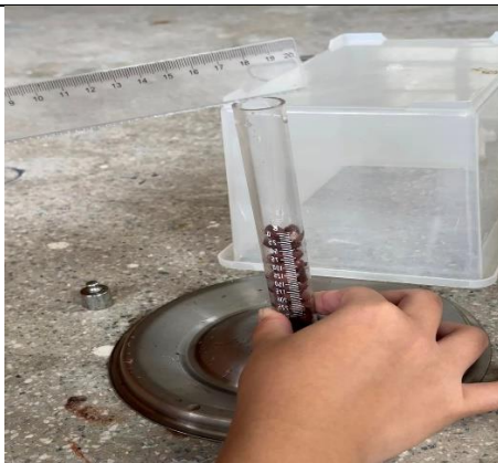
敲擊檢測器一分鐘使檢測器內之紅豆盡量扎實，並記錄高度
