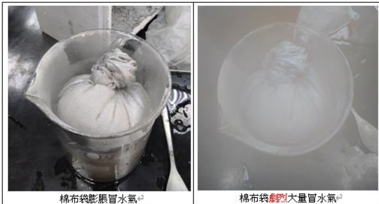
圖(20) 成功的放熱反應，使水大量冒水氣
