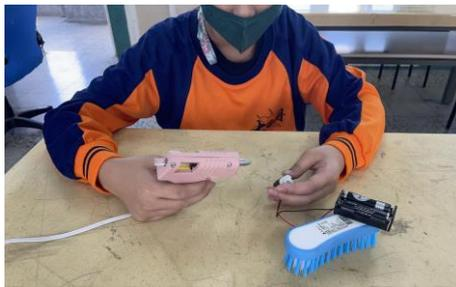
3.將馬達及電池座用熱溶膠固定在刷子上。
