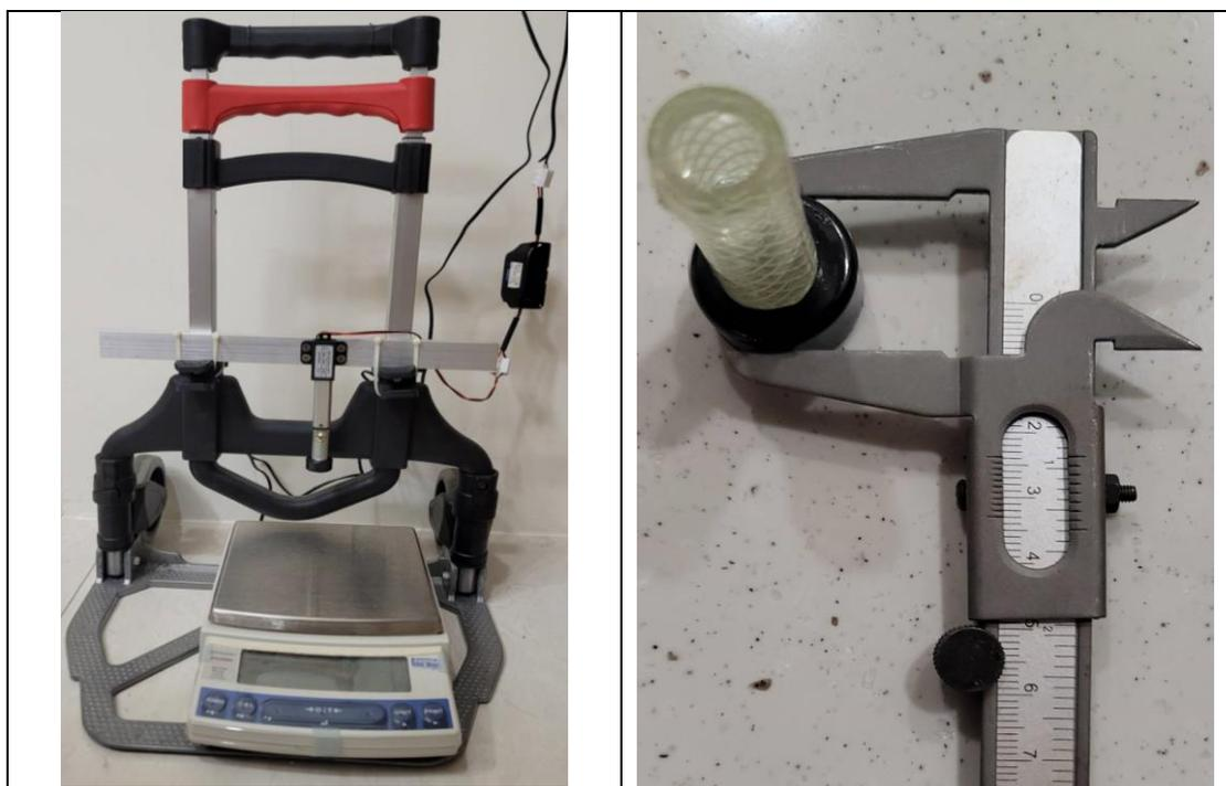
圖 3.3 自製物性試驗機裝置設計圖（實物自拍）
